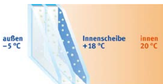
3fach Isolierglas mit Beschichtung und Gasfüllung
