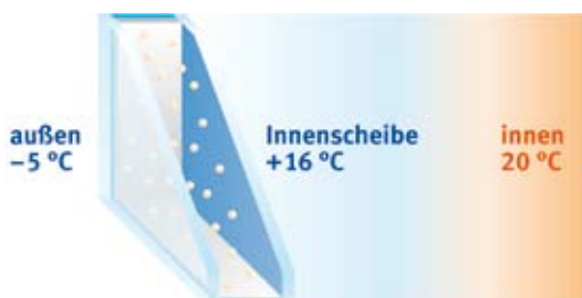
2fach Isolierglas mit Beschichtung und Gasfüllung
